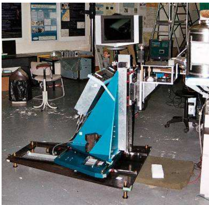
Fig. 9 – Sistema utilizado para suporte das amostras e varrimento mecânico
