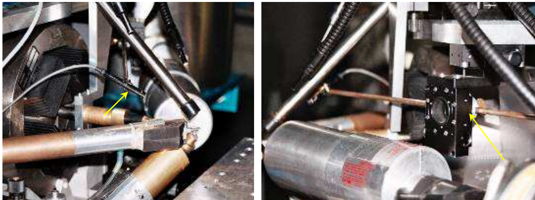
Figs. 4 e 5 – Câmara de vídeo e respectivo sistema de posicionamento (indicados pelas setas amarelas).
